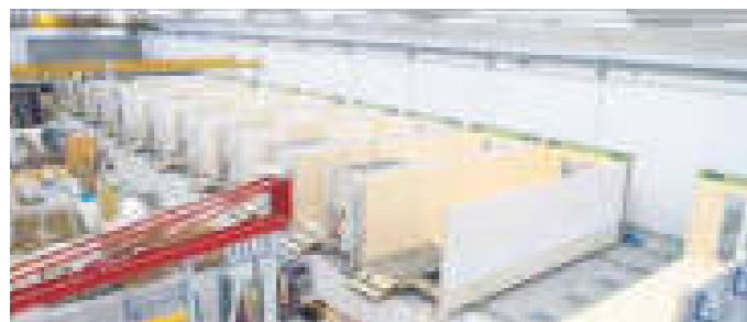
Bisherige Produktionsstätte mit 14 Arbeitsstationen: Hier wurden komplette Räume montiert, von der Holzwand bis zur Einbauküche.
