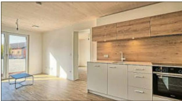
Diese Dreizimmerwohnung ist schlüsselfertig in Modulbauweise erstellt. Die Einbauküche wurde bereits in der Produktionshalle eingebaut.
